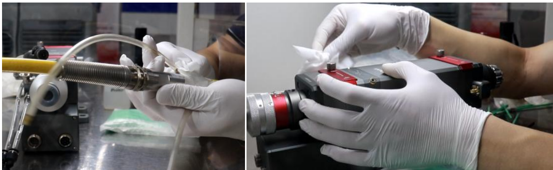
图 18 清洁光纤接头和激光头
